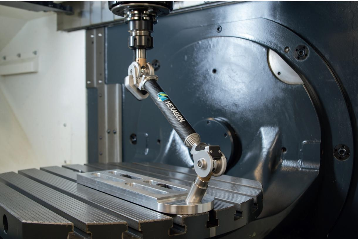
1 Schnell zum geometrischen Fingerprint einer Werkzeugmaschine: Etalon präsentiert auf der EMO den X-AX Laserbar zur teilautomatisierten volumetrischen Erfassung der Genauigkeit aller Linear- und Drehachsen einer Werkzeugmaschine in ihrem Zusammenwirken (© Hexagon)
